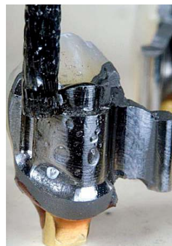
Подготовка отфрезерованного плеча с фрезерным маслом для получения более гладкой поверхности и более длительной эксплуатации фрез
