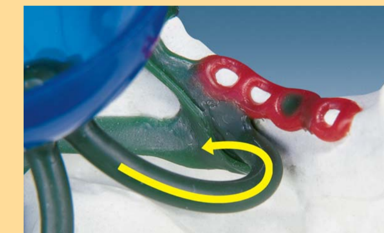
Установка литников к самому толстому месту моделировки
