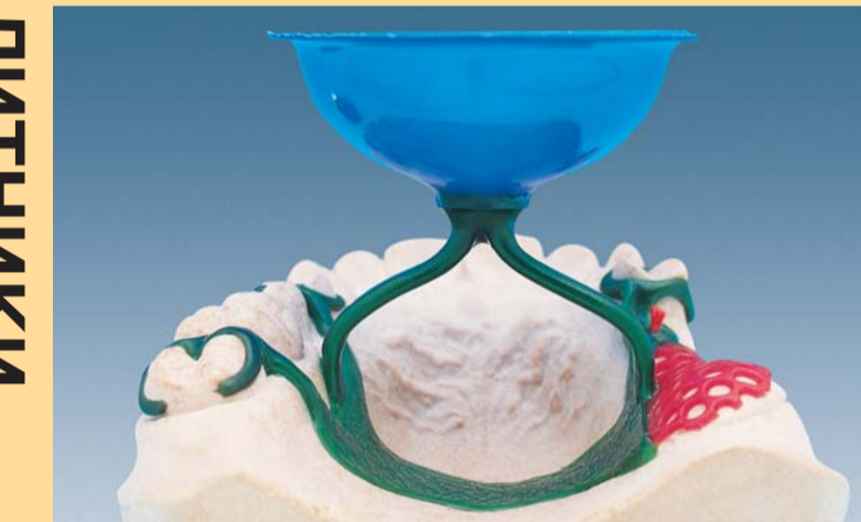
Литьевая воронка устанавливается на 10мм выше окклюзионной плоскости
